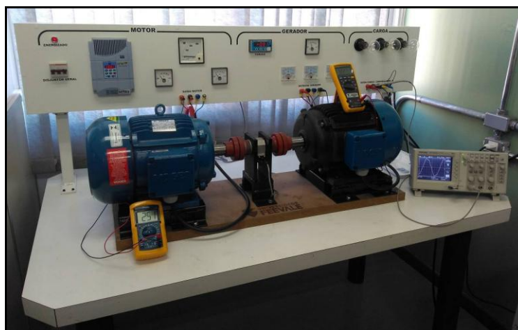
Figura 12 – Máquina Síncrona de 7,5 kW em testes na Bancada
