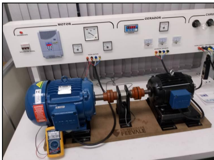
Figura 13 – Máquina Síncrona de 2,5 kW em testes na Bancada
